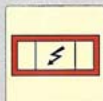
0686 06 60 quadro elettrico d'emergenza
