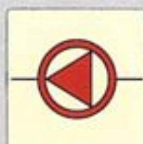
0686 01 80 pompa antincendio d'emergenza
