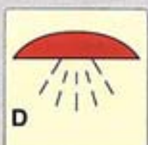
0686 03 20 spazio protetto da impianto di spegnimento
