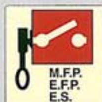
0686 06 70 pompe antincendio o interruttori d'emergenza telecomandati
