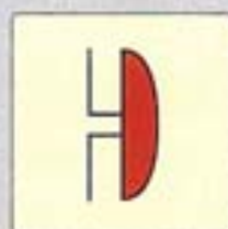
0686 00 70 companello allarme antincendio
