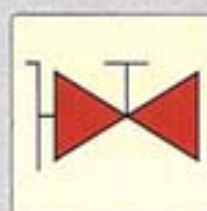
0686 02 40 impianto antincendio principale con valvola
