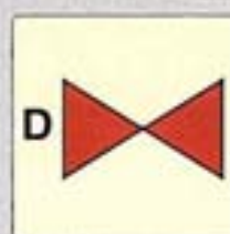
0686 02 10 sezione valvole impianto di spegnimento
