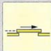
0686 06 00 porta antincendio a chiusura automatica classe B
