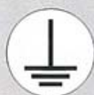
1159 70 10 messa a terra
