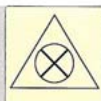
0686 03 00 chiusura telecomandata della ventilazione
