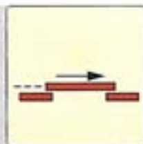
0686 05 50 porta antincendio a chiusura automatica classe A
