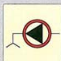
0686 02 00 pompa di sentina d'emergenza
