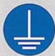
1160 02 90 messa a terra
