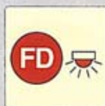
0686 00 90 spazio protetto da allarme antincendio automatico
