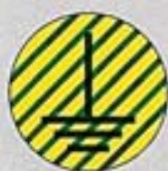
1160 00 10 messa a terra
